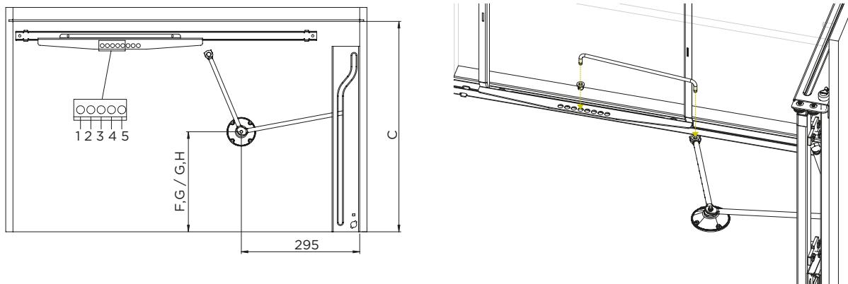
Соедините поворотный рычаг I с задней рамой при помощи планки M и пластиковой втулки L (см. схему). При необходимости отрегулируйте вылет задних корзин, перемещая планку M в наиболее подходящее отверстие на раме.
