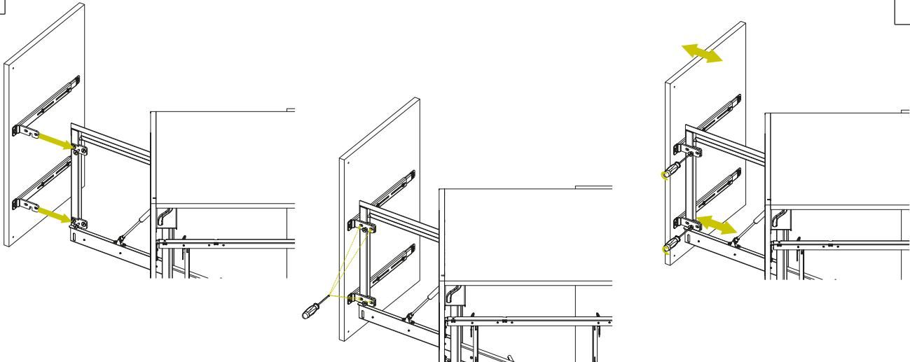
Установите фасад с кронштейнами на боковую раму и зафиксируйте его с помощью винтов.
