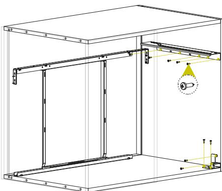
Зафиксируйте планку В и нижнюю петлю F согласно разметке по шаблону или указанным присадкам.
