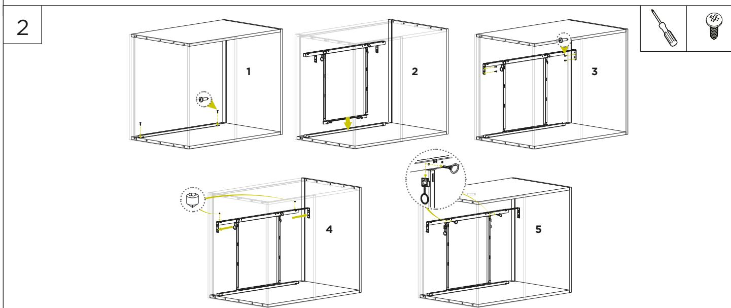
Закрепите заднюю раму в соответствии с разметкой шаблона и зафиксируйте винтами распорные уголки.
