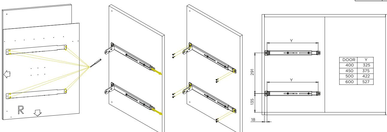
Сделайте разметку фасада согласно шаблона или размеров присадок. Зафиксируйте фасадные кронштейны Н согласно разметке.
