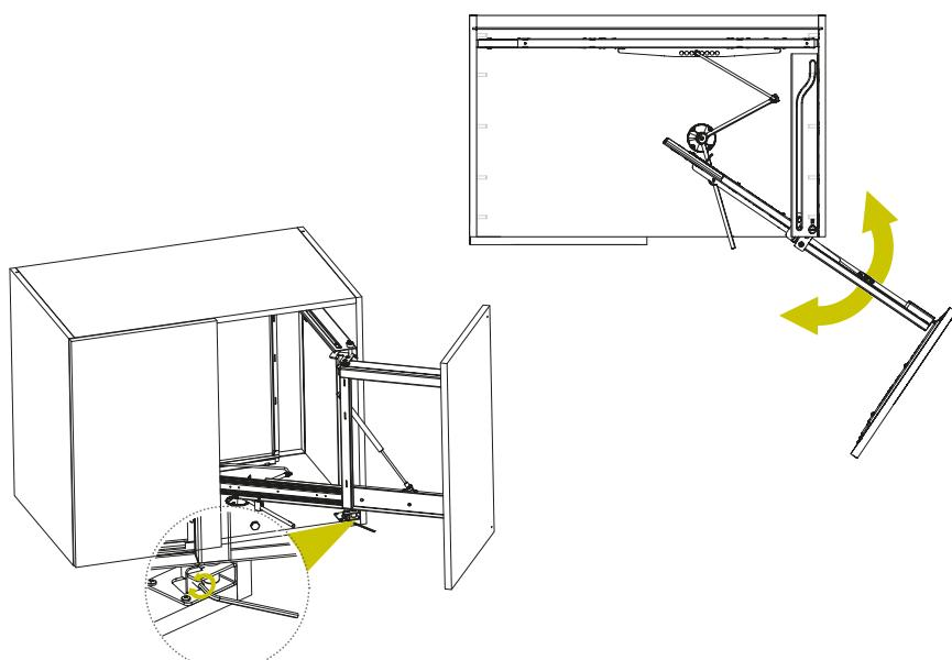
Отрегулируйте вылет передних корзин, при помощи ограничительного винта на нижней петле F.
