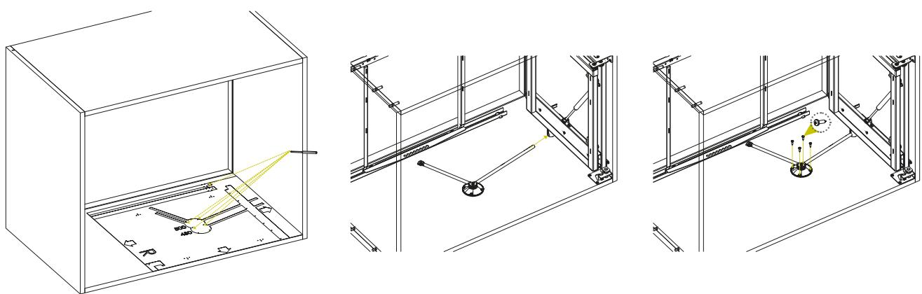
Зафиксируйте поворотный рычаг I (согласно разметке, пункт 1), совместив его с проушиной в боковой раме.
